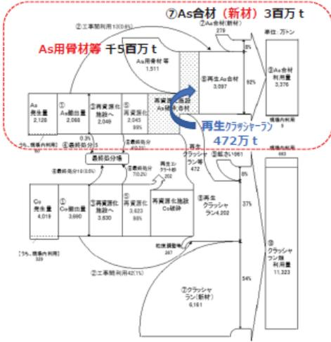
アスファルト・コンクリート塊、コンクリート塊のリサイクルフロー
