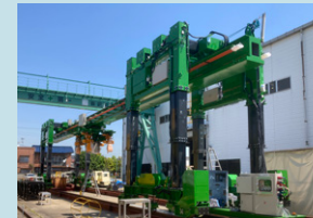
プレキャスト床版架設機の開発
