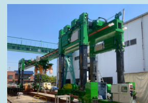
プレキャスト床版架設機の開発
