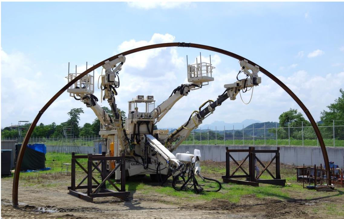
写真-1 鋼製支保工建込みロボット全景
